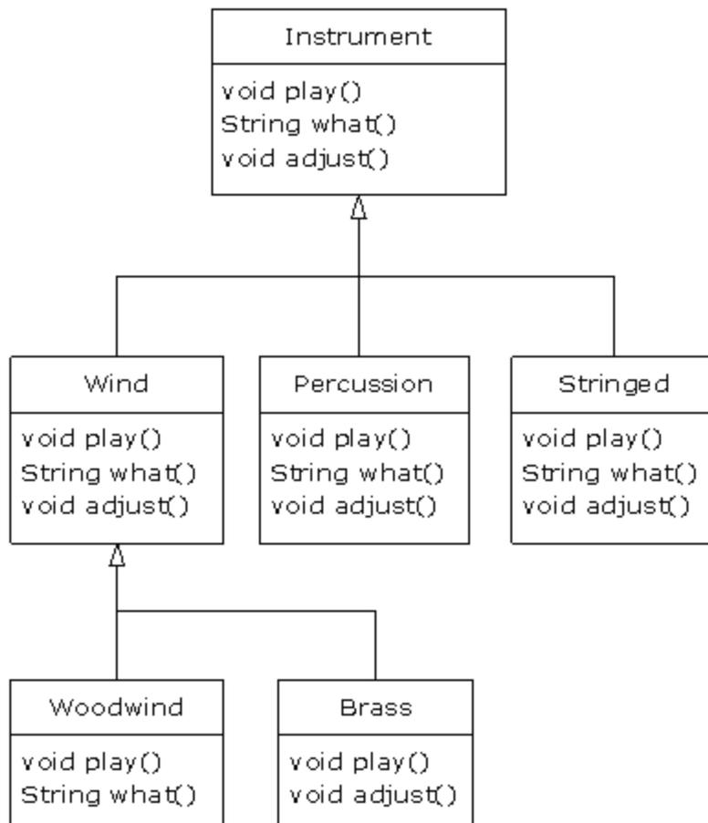
这些新的类都能同原先未作修改的 **tune()** 方法协同工作。即便是在 **tune()** 保存在另一个文件，而 **Instrument** 的接口已经加入了新方法的情况下，它也能无须重新编译而正常工作。下面就是这个关系图的实现：
