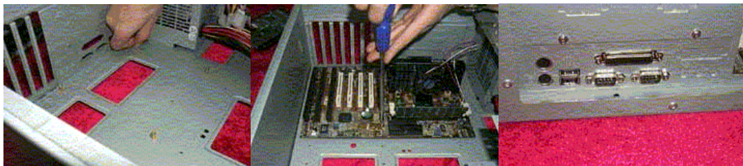
图 2.6 主板的固定（步骤为左、中、右）
